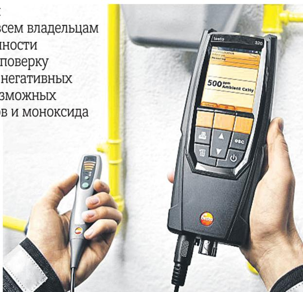
Газоанализатор позволяет определить количество летучего вещества в воздухе и своевременно принять меры при превышении допустимого порога. Если в помещении превышена концентрация газа, сигнализатор подает сигнал на электромагнитный клапан, который устанавливается на входе газопровода в здание. Клапан в случае возникновения загазованности перекрывает подачу газа в помещение.
