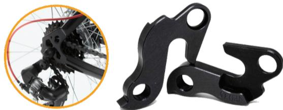
Петух - элемент, на который устанавливается задний переключатель скоростей. Он может деформироваться при ударах по переключателю, и его можно выпрямить вручную, однако лучше произвести полную замену.
