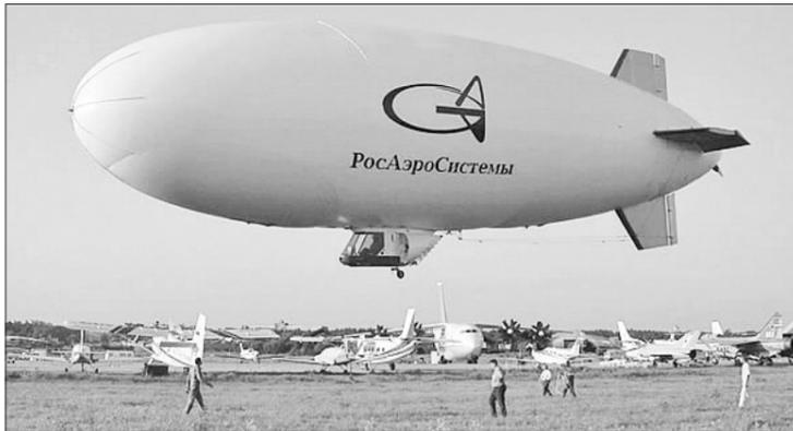
модель термоплана АЛА-040 с расчетной грузоподъемностью 3 тонны вывезли на аэродром. Однако от сильного ветра и неадекватных действий техников конструкция деформировалась, и произошел разрыв оболочки. Вскоре проект был закрыт, а останки аппарата долгие годы, а может быть, и до сих пор пылятся где-то на ульяновском авиазаводе...
