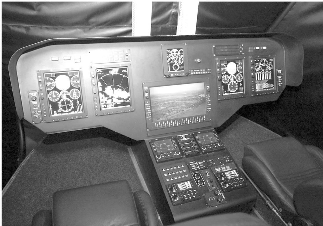
Новый интегрированный комплекс бортового оборудования, разработанный ульяновским бюро приборостроения, будет установлен на гражданский вертолет Ми-171А2. Это глубокая модернизация самого массового вертолета в России Ми-8, которая отличается своей многофункциональностью
