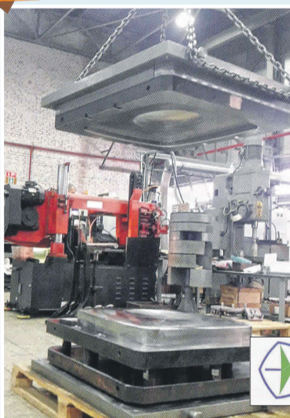
Изготовление технологической оснастки: пресс-форм, штампов
