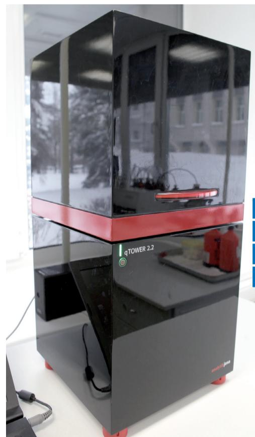
■ Аппарат для проведения ПЦР-диагностики в реальном времени позволяет намного сократить исследования ДНК.
